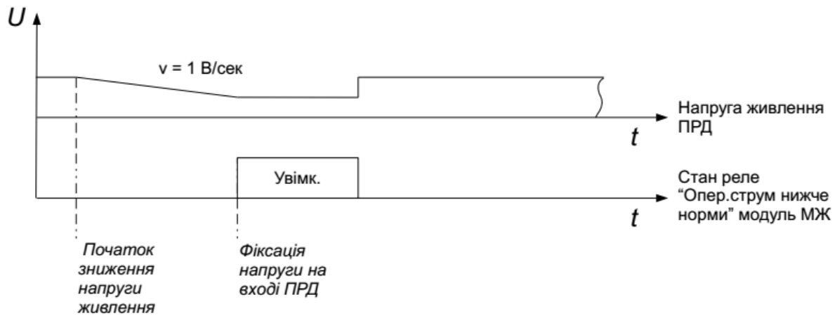
Рисунок 8.13.4 – Часова діаграма перевірки сигнал. «Опер. струм нижче норми»
