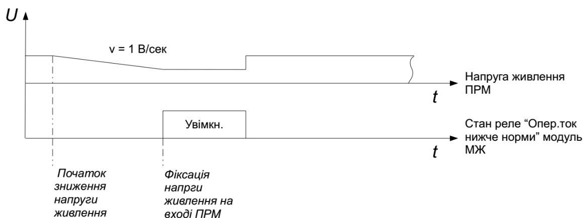
Рисунок 8.15.2 – Часова діаграма перевірки сигнал. «Опер.струм нижче норми»
