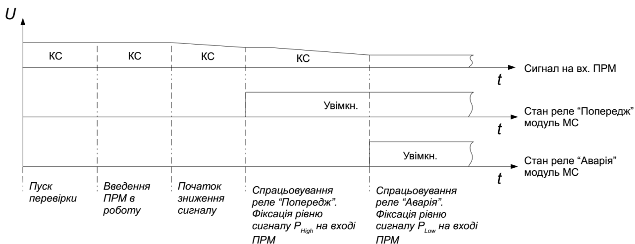
Рисунок 8.12.1 – Часова діаграма перевірки компараторів «High» і «Low»
