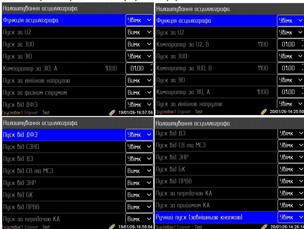
Рисунок 5.5.12.1. Меню налаштувань осцилографа
