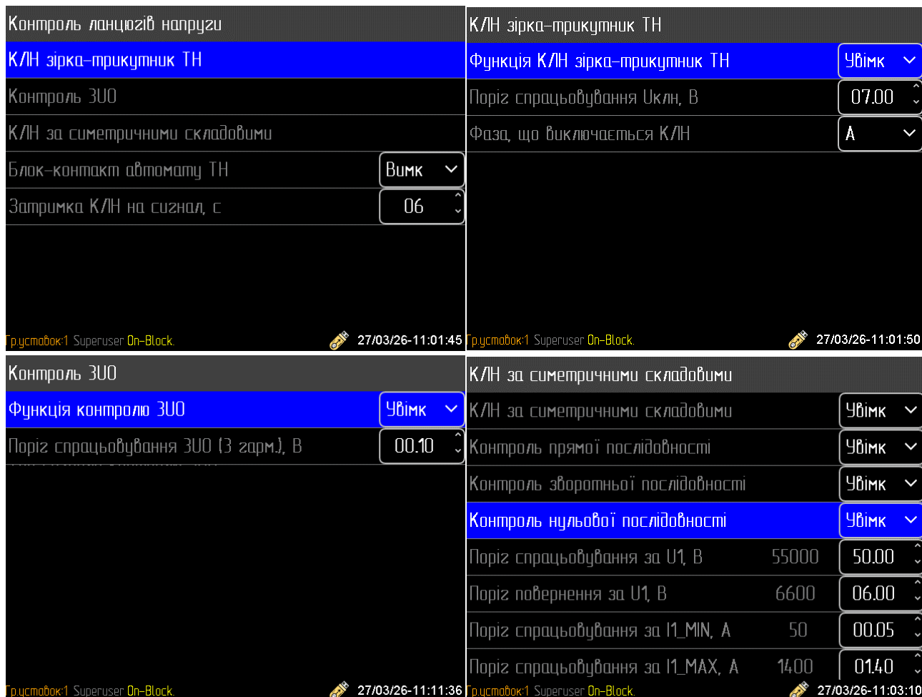
Рисунок 5.5.9.1 – Контроль ланцюгів напруги
