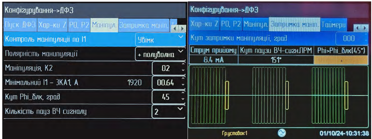
Рисунок 5.4.4.1 – Налаштування диференційно-фазного захисту.
