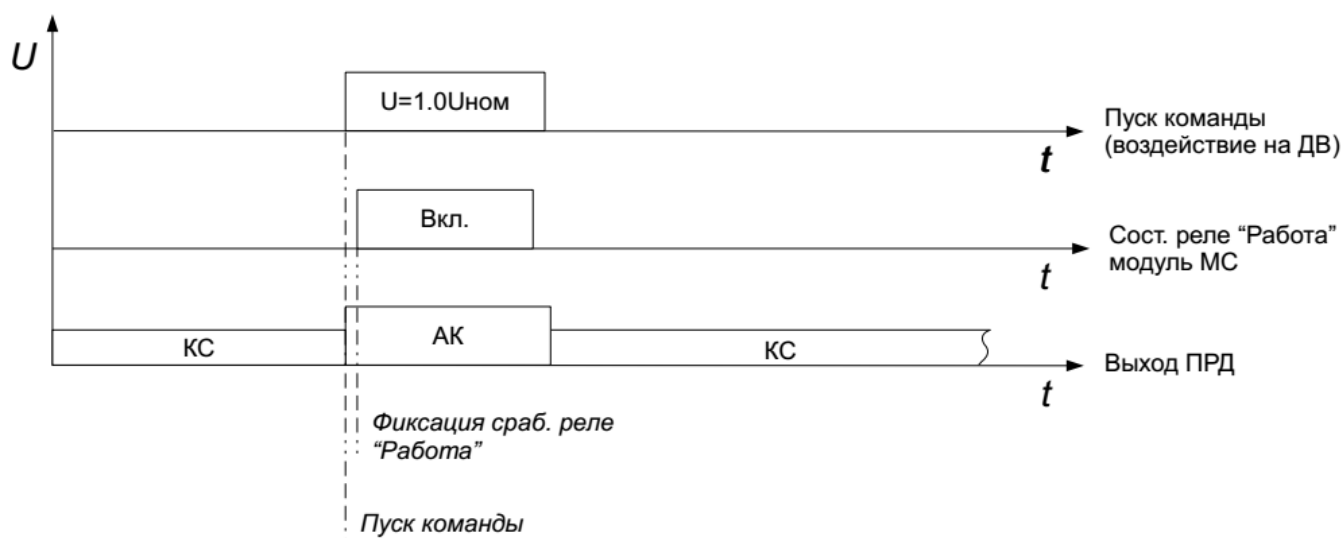
Рисунок 8.14.1 – Временная диаграмма проверки сигнал. «Работа»
