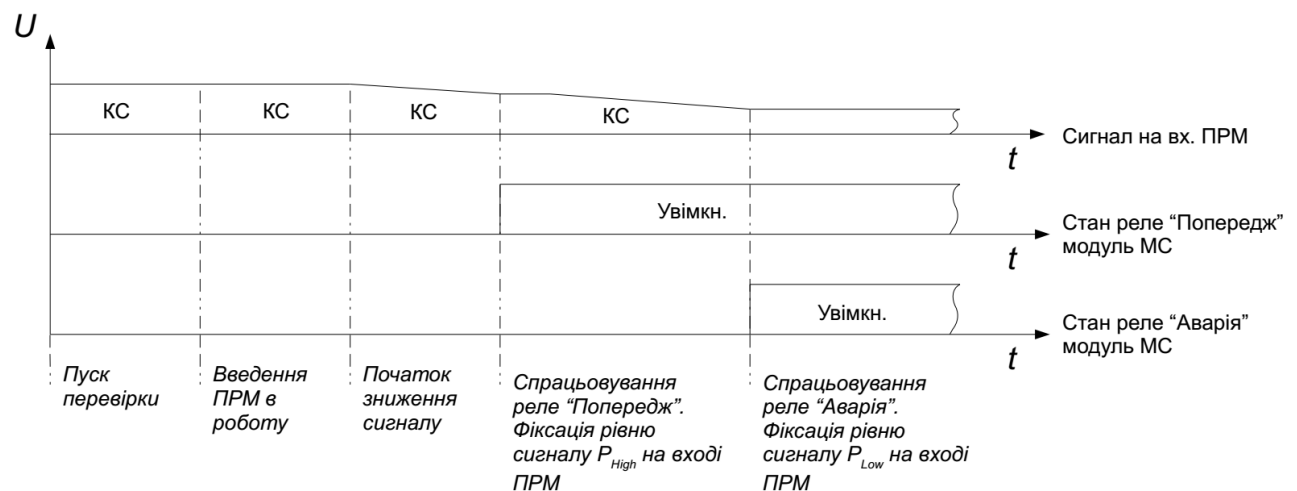
Рисунок 8.12.1 – Часова діаграма перевірки компараторів «High» і «Low»
